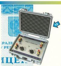
Имитаторы термопреобразователей МК3002. Воспроизведение сопротивления платиновых и медных термосопротивлений. Погрешность до 0.012°C. Каналов - 2.
