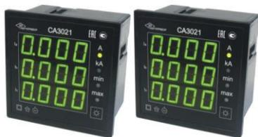
Все приборы серии 3021 подключаются непосредственно к измерительным трансформаторам тока (ИТТ) и (или) измерительным трансформаторам напряжения (ИТН). Приборы измеряют действующие значения тока, напряжения, активную и реактивную мощность, частоту сети и передают измеренные значения параметров сети по **гальванически развязанному** интерфейсу RS485.
