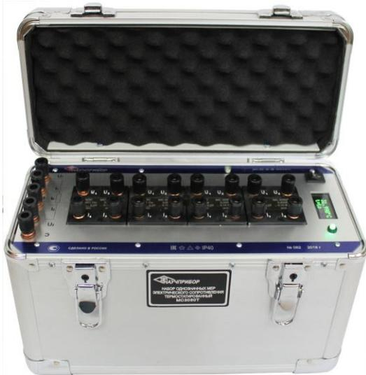
Изготовлен на базе **особостабильных прецизионных однозначных мер электрического сопротивления (ОМЭС) МС3050**, имеющих высочайшие метрологические характеристики и использующихся в промышленно развитых странах, в том числе в национальных эталонах Ома, а также всех метрологических и научных центрах России.
